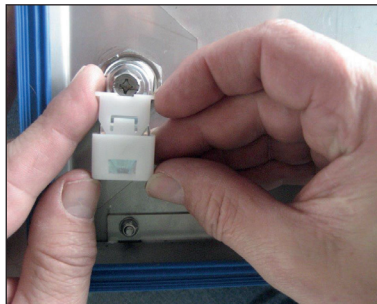
Verriegelungskeil einschieben und einrasten
