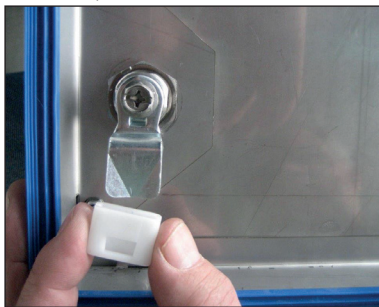
Positionner la languette sur la came
