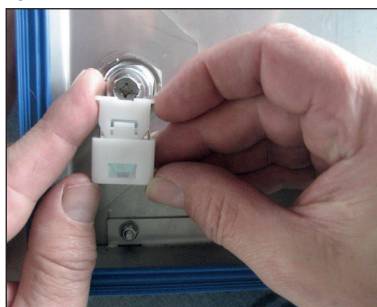
Insérer et positionner le dispositif de verrouillage
