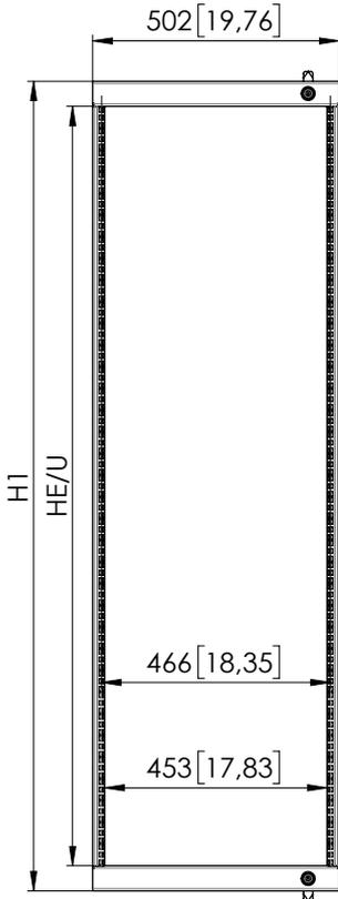
Cadre pivotant pour armoires de 800 mm de largeur, montage latéral
