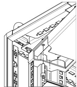
**Montage Schwenkrahmen für Breite 800 mit Schwenksatz 165° 0318-7080-18-07**
