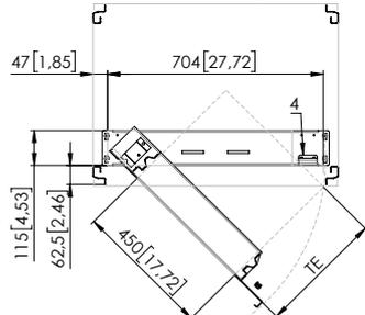
Option de montage pour cadre pivotant pour armoires de 800 mm de largeur avec jeu de fixation pivotant
