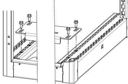
**Montage Schwenkrahmen für Breite 600 und 800**
