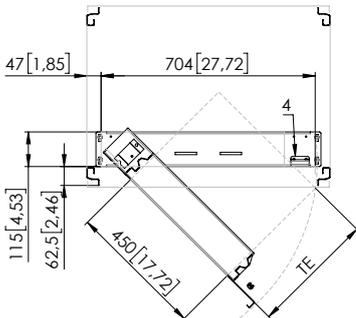
Einbauvariante Schwenkrahmen für Breite 800 mit Schwenksatz
