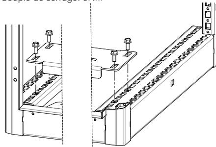
**Montage du cadre pivotant dans de 600 mm et 800 mm de largeur**
