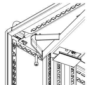
Cadre pivotant pour armoires de 600 mm de largeur
