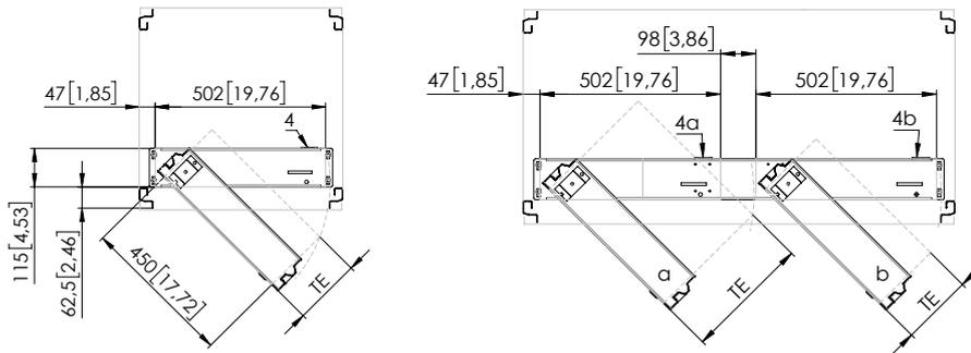
Einbauvarianten Schwenkrahmen für Breite 800 seitlich
