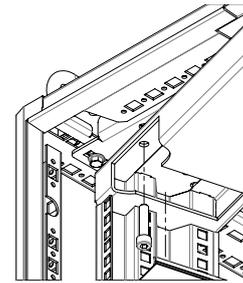
**Montage du cadre pivotant dans des armoires de 800 mm de largeur avec jeu de fixation pivotant 165° type 0318-7080-18-07**
