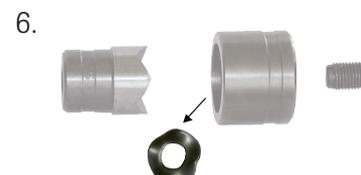
Décharger la pompe en ouvrant la vis de retour d'huile. Le poinçon reprend sa position de départ par la force du ressort. Dévisser le poinçon et la matrice et enlever les débouchures.
