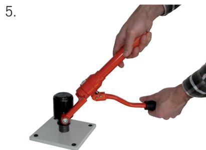
Fermer la vis de retour d'huile. Actionner la pompe jusqu'à ce que le poinçon ait perforé la tôle complètement (craquement perceptible). Pomper lentement pour que le poinçon puisse se mettre en place. Après le craquement (la découpe), actionner la pompe 2-3 fois jusqu'à ce que les débouchures tombent dans la matrice.
