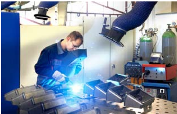
Poste de travail soudeur avec aspiration directe
