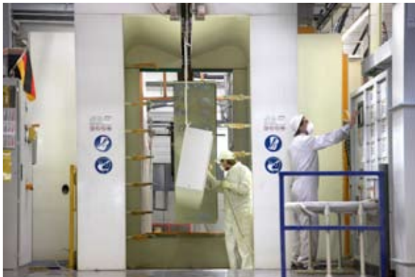
Vernissage sans production d'eaux usées grâce au revêtement par poudre
